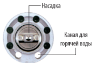
Обогревательная рубашка в разрезе, на рис. изображены каналы для жидкости
