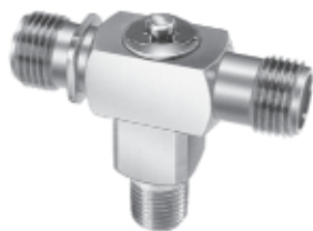
23830 Впуск: 1/4" NPT или BSPT (наружн. или внутр. резьба) или 11/16" - 16 (внутр. резьба) для UniJet Выпуск: 11/16" - 16 (наружн. резьба)
